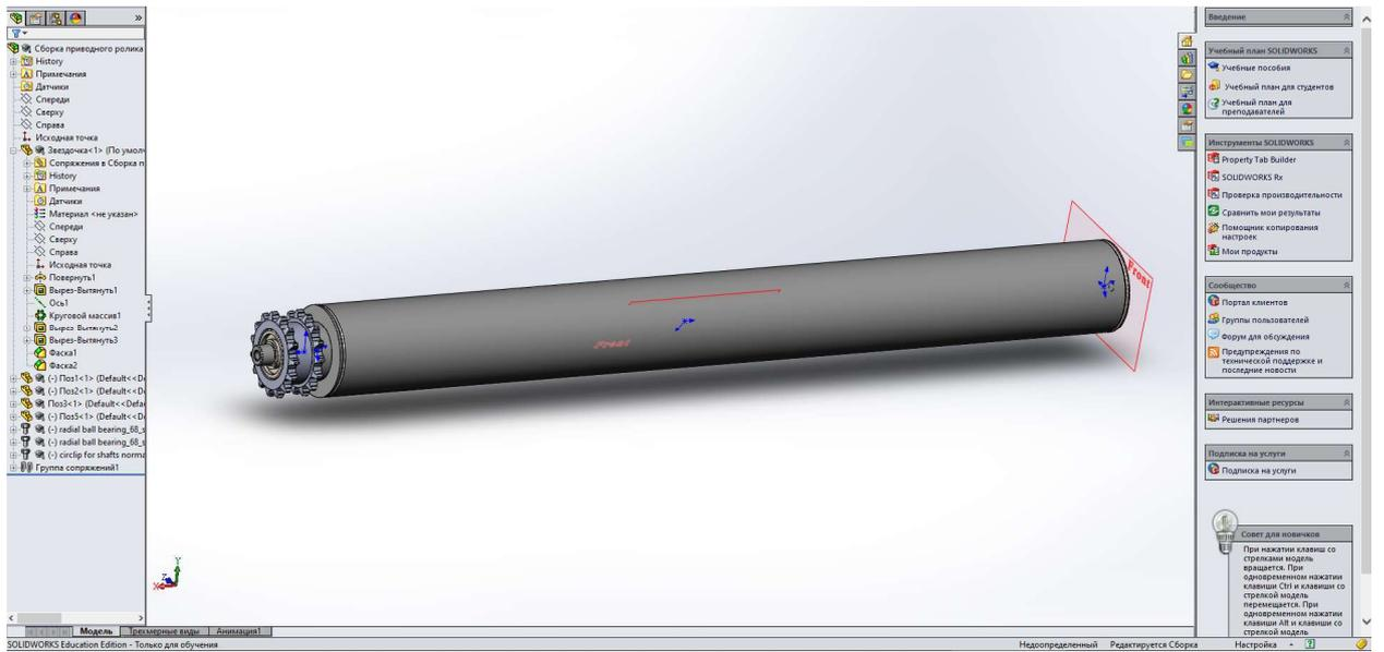
Рисунок 2. Приводной ролик
